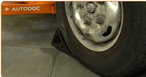
4 Afloje las tuercas de la rueda. Utilice un vaso de impacto para ruedas de 21 mm. Utilice una llave giramachos con mango en T.
