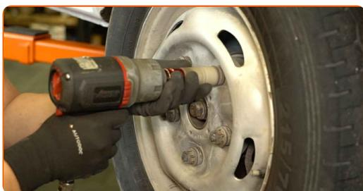
Sustitución: pastillas de freno - FORD Transit Mk6 Caja / Chasis (V347, V348).
