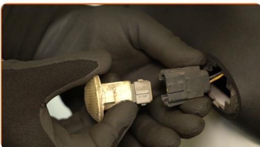
**3** Trate el conector del repetidor del intermitente. Utilice un spray para contactos eléctricos.
