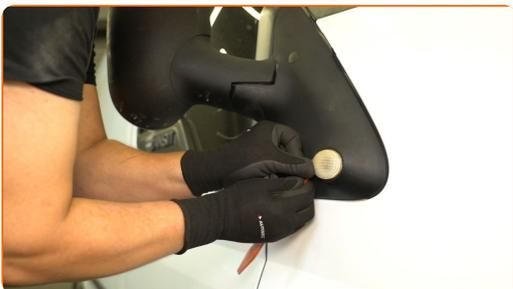
**2** Separe el conector de la luz repetidora lateral.
