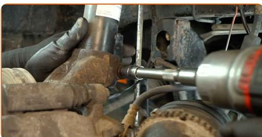
**41** Retire el perno de sujeción.
