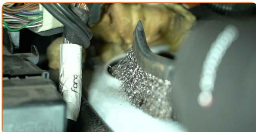
**7** Afloje las sujeciones del soporte del puntal. Utilice una llave de vaso de 13 mm. Utilice una llave de carraca.
