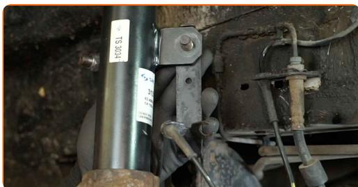
**78** Apriete la sujeción que conecta la bieleta de la barra estabilizadora al puntal de suspensión. Utilice una llave de vaso de 19 mm. Utilice una llave dinamométrica. Par de apriete: 55 N·m.
