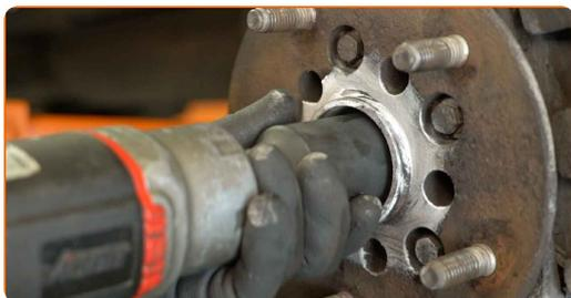
**26** Retire la arandela del eje. Utilice una herramienta de recogida magnética telescópica.
