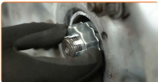
**91** Instale el pasador de chaveta. Utilice una palanca de montaje.
