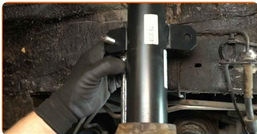
**77** Instale el soporte del cable del sensor ABS y enrosque la tuerca de sujeción.
