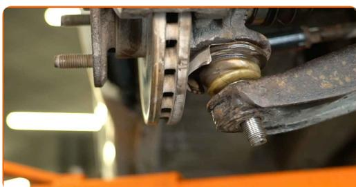
**76** Instale la bieleta de la barra estabilizadora y enrosque la tuerca de sujeción.
