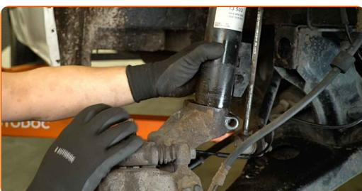
Sustitución: amortiguador telescópico - FORD Transit Mk6 Camión de plataforma/Chasis (V347, V348). Consejo:
