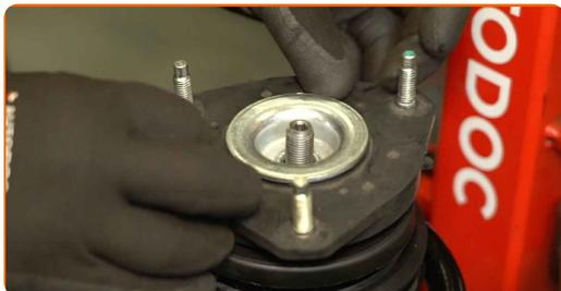
**64** Instale y apriete la tuerca del vástago del pistón del puntal. Utilice una llave de vaso de 18 mm para tuercas de puntal. Utilice una barra de extensión hexagonal H6. Utilice una llave dinamométrica. Par de apriete: 70 N·m.
