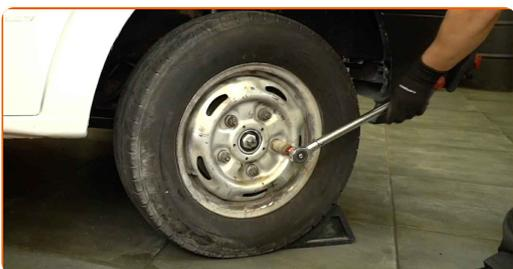
**89** Apriete la tuerca del eje. Utilice una llave de vaso de 36 mm. Utilice una llave dinamométrica. Par de apriete: 320 N·m.
