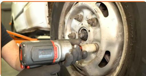
**88** Baje el coche y apriete las tuercas de la rueda siguiendo un orden entrecruzado. Utilice un vaso de impacto para ruedas de 21 mm. Utilice una llave dinamométrica. Par de apriete: 200 N·m.
