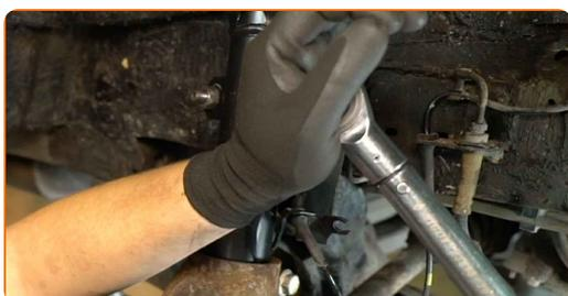
**80** Levante la mangueta de dirección por medio de un gato.
