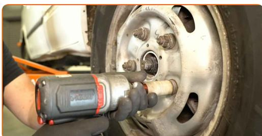
**84** Baje el coche y apriete las tuercas de la rueda siguiendo un orden entrecruzado. Utilice un vaso de impacto para ruedas de 21 mm. Utilice una llave dinamométrica. Par de apriete: 200 N·m.
