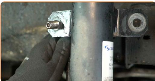
**25** Desenrosque la tuerca del eje. Utilice una llave de vaso de 36 mm. Utilice una llave de carraca.
