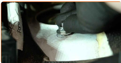
Sustitución: copelas del amortiguador - FORD Transit Mk6 Camión de plataforma/Chasis (V347, V348). Los expertos de AUTODOC recomiendan:
