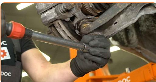
**80** Limpie el asiento de montaje de la llanta. Utilice un cepillo de alambre. Utilice un spray limpiador multiusos.
