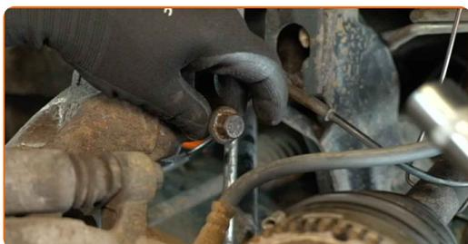
**42** Desconecte la mangueta de dirección del puntal de suspensión. Utilice un mazo de goma. Utilice un gato para transmisión o un gato para vehículos adicional.
