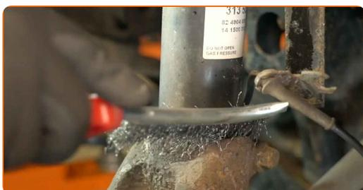
**21** Desenrosque la sujeción del soporte del cable del sensor ABS. Utilice una llave de vaso de 18 mm. Utilice una llave de carraca.
