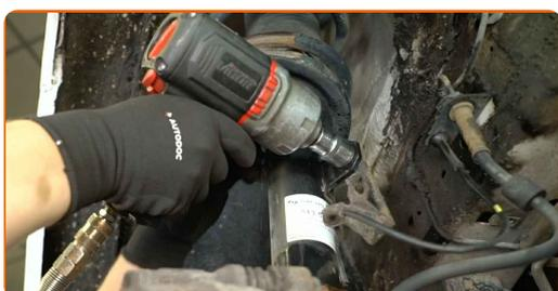
**22** Separe el soporte del cable del sensor ABS del puntal de suspensión.
