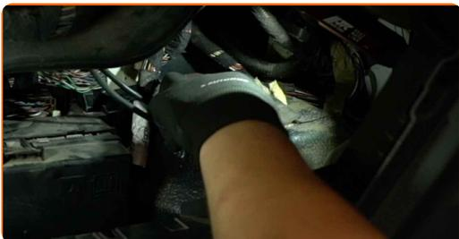
**92** Instale la guantera presionando hacia abajo sus lengüetas de retención.
