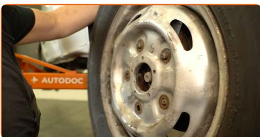
**11** Desenrosque la tuerca del eje. Utilice una llave de vaso de 36 mm. Utilice una llave de carraca.
