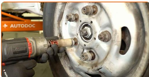
**56** Baje el coche y apriete las tuercas de la rueda siguiendo un orden entrecruzado. Utilice un vaso de impacto para ruedas de 21 mm. Utilice una llave dinamométrica. Par de apriete: 200 N·m.
