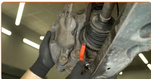
**18** Desenrosque las sujeciones del soporte de la pinza de freno. Utilice una llave de vaso de 18 mm. Utilice una llave giramachos con mango en T.
