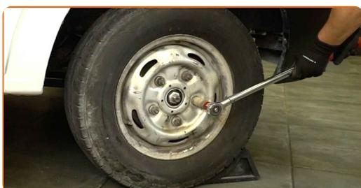
**57** Apriete la tuerca del eje. Utilice una llave de vaso de 36 mm. Utilice una llave dinamométrica. Par de apriete: 320 N·m.
