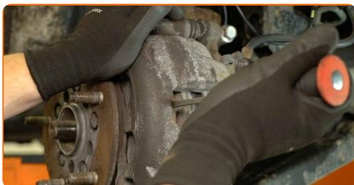
**17** Limpie las sujeciones del soporte de la pinza de freno. Utilice un cepillo de alambre. Utilice el spray WD-40.
