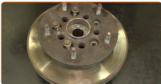
**39** Atornille las sujeciones del disco de freno. Utilice una llave de vaso de 13 mm. Utilice una llave de carraca.
