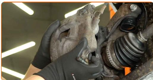
Sustitución: cojinete de rueda - FORD Transit Mk6 Camión de plataforma/Chasis (V347, V348). AUTODOC recomienda:
