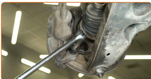
**19** Retire los pernos de sujeción. Utilice una llave de carraca.
