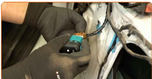
**33** Trate el conector del altavoz. Utilice un spray para contactos eléctricos.
