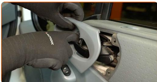
**4** Retire los tornillos de sujeción.
