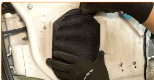
**37** Instale y atornille los tornillos de sujeción del altavoz. Utilice un destornillador Phillips.
