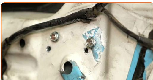
**22** Apriete las sujeciones del mecanismo del elevallunas. Utilice una llave de vaso de 10 mm. Utilice una llave dinamométrica. Par de apriete: 8 N·m.
