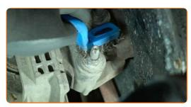
Desenrosque los elementos de sujeción inferiores del soporte del motor. Utilice una llave de vaso de 13 mm. Utilice una llave de trinquete.
