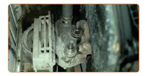
Retire el soporte del motor.
