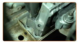
Apriete los elementos de sujeción superiores del soporte del motor. Utilice una llave de vaso de 18 mm. Utilice una llave dinamométrica. Par de apriete: 115 N·m.
