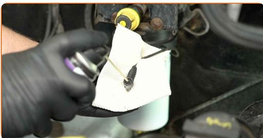
**9** Una el conector del sensor de agua en el combustible.
