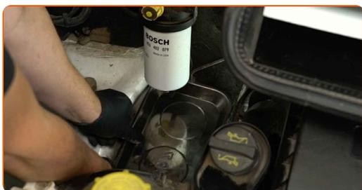
**4** Limpie la superficie de montaje del filtro. Utilice un spray limpiador multiusos.
