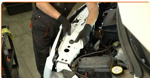
**41** Instale y enrosque los pernos de sujeción de la cubierta de soporte superior del radiador.
