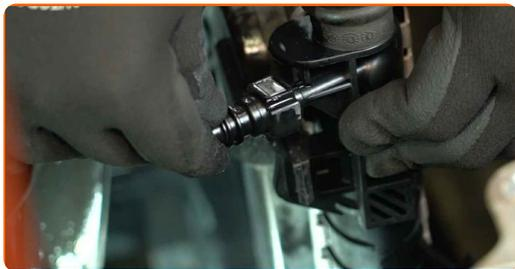
**40** Instale la cubierta de soporte superior del radiador.
