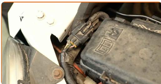
**48** Una la manguera superior de líquido refrigerante. Utilice unos alicates para abrazaderas de manguera.
