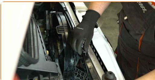
**39** Retire el tapón de la manguera de rebose y una su conector al radiador.
