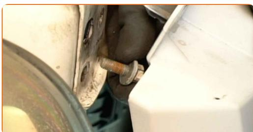
**26** Retire la cubierta de soporte superior del radiador.
