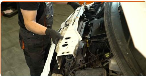
**27** Separe el conector de la manguera de rebose del radiador y cierre la manguera por medio de un tapón. Utilice unos alicates para líneas de combustible.
