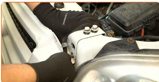
**42** Apriete las sujeciones de la cubierta de soporte superior del radiador. Utilice una llave de vaso de 13 mm. Utilice una llave dinamométrica. Par de apriete: 22 N·m.
