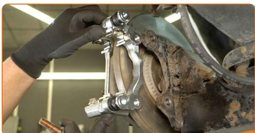
23 Instale y enrosque los pernos de sujeción.
