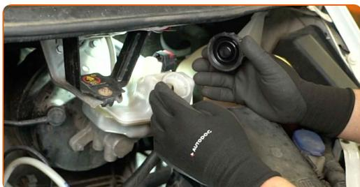
38 Apriete el tapón del depósito del líquido de frenos.
