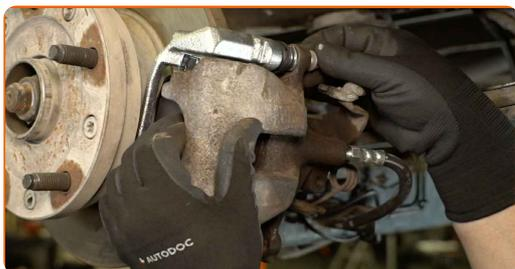
28 Instale y enrosque los pernos de sujeción.
