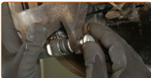
29 Apriete las sujeciones de la pinza de freno. Utilice una llave combinada de 18 mm. Utilice una llave de vaso de 13 mm. Utilice una llave dinamométrica. Par de apriete: 31 N·m.
