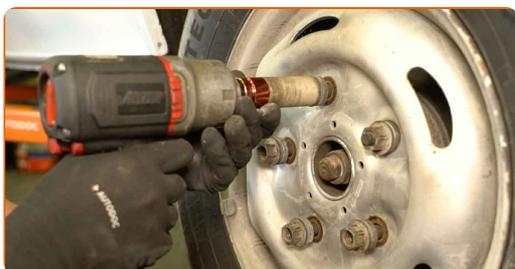
34 Baje el coche y apriete las tuercas de la rueda siguiendo un orden entrecruzado. Utilice un vaso de impacto para ruedas de 21 mm. Utilice una llave dinamométrica. Par de apriete: 200 N·m.
