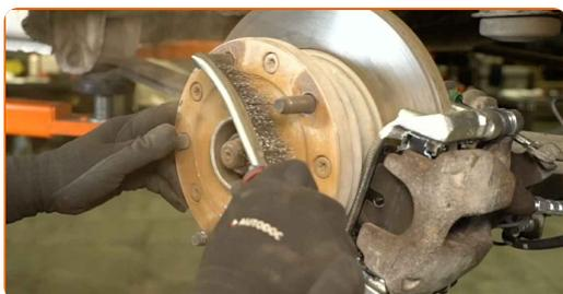
31 Trate la superficie en la que el cubo de rueda entra en contacto con la llanta. Utilice grasa cerámica.
