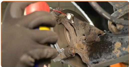
**16** Desenrosque las sujeciones del soporte de la pinza de freno. Utilice una llave combinada de 15 mm.
