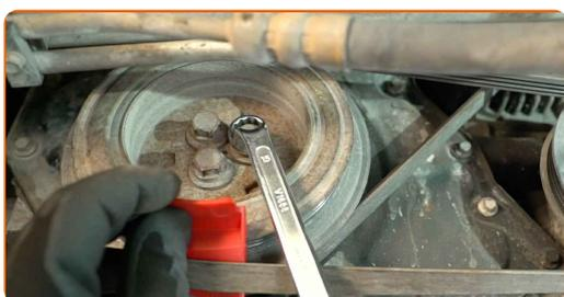
**3** Retire la correa poli V del alternador girando para ello la polea del cigüeñal. Utilice una herramienta de extracción/instalación de correas elásticas. Utilice una palanca de montaje. Utilice una llave combinada de 15 mm.
