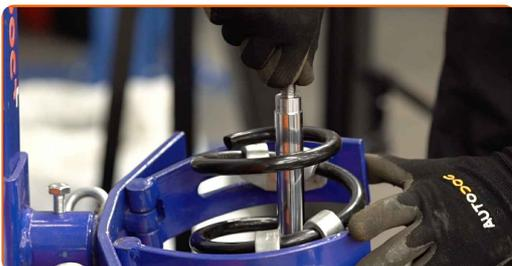
28 Instale la cazoleta, el guardapolvos y el tope en el amortiguador nuevo.
