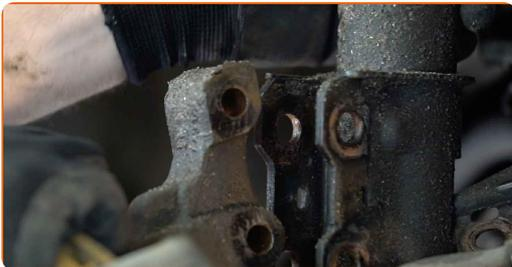
15 Destornille la fijación superior de la pata amortiguadora. Use una llave mixta del n.º 19. Use un vaso de impacto del n.º 9. Utilice una llave de trinquete.
