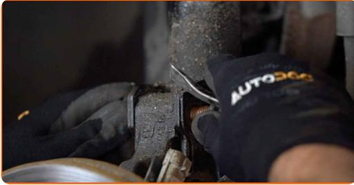
13 Desconecte la fijación de la manguera de freno de la conexión con la pata amortiguadora. Use una palanca.
