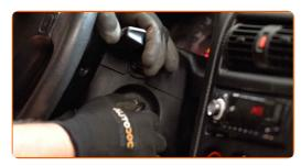
Empuje la palanca del limpiaparabrisas hacia una posición descendente. Al hacer esto, usted cambiará los limpiaparabrisas del modo servicio al modo operación.
