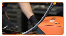
Aparte la palanca de limpiaparabrisas fuera de la superficie de cristal hasta el fin.
