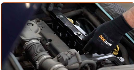
**14** Apriete la atadura de la bobina del encendido. Utilice Torx T30. Utilice una llave dinamométrica. Apriételo a un par de 15 Nm.
