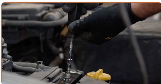
**15** Trate el conector de la bobina de encendido con spray para electrónica. El spray protegerá los contactos eléctricos de la corrosión, oxidación, y reducirá la resistencia de contacto.
