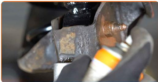
**27** Trate la superficie donde el disco del freno entra en contacto con la llanta de la rueda. Use grasa de cobre.
