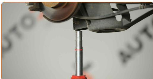
**8** Destornille la fijación inferior del amortiguador. Usa una llave mixta del n.º 16. Use un vaso de impacto del n.º 16. Utilice una llave de trinquete.
