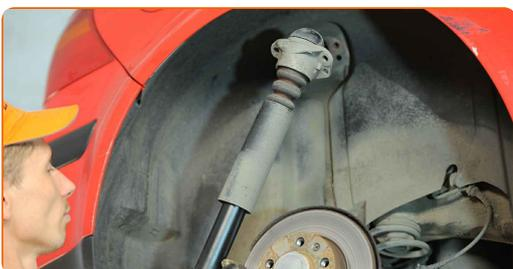
**12** Quite la tapa de protección del soporte del amortiguador. Utilice un destornillador plano.
