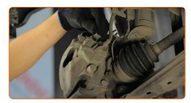
Instale el resorte de fijación del cáliper de freno. Utilice un destornillador plano. Utilice alicates.
