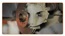
Use Vaso HEX No. H7. Utilice una llave dinamométrica. Apriételo a un par de 30 Nm.
