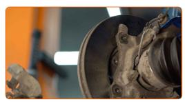
Limpie la sujeción del disco de freno. Use un cepillo de alambre. Use el aerosol WD-40.
