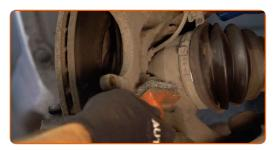
Destornille la fijación de la pinza del cáliper de freno. Use un vaso de impacto del n.º 18. Utilice una llave de trinquete.
