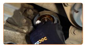
Atornille el filtro nuevo en su sitio. Utilice el vaso 76/14-F. Utilice una llave dinamométrica. Apriételo a un par de torsión de 22 Nm.
