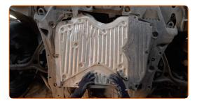
Atornille las sujeciones del aislante acústico inferior. Use un vaso de impacto del n.º 10. Utilice una llave de trinquete.
