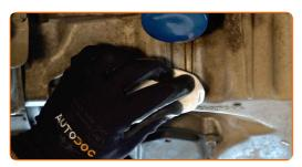
Atornille en el nuevo tapón de drenaje y apriételo. Use un vaso de impacto del n.º 17. Utilice una llave dinamométrica. Apriételo a un par de 38 Nm.
