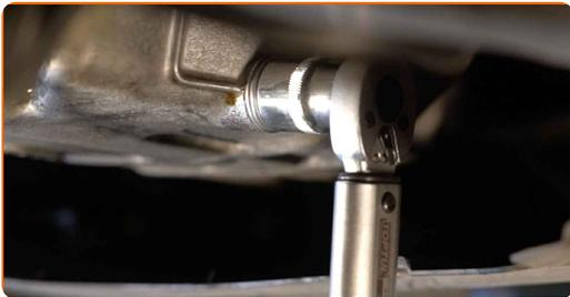
8 Limpie el área del orificio de drenaje de la bandeja de aceite. Utilice un spray de limpieza multiuso.
