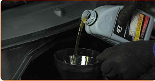
Sustitución: aceite de motor y filtro - HONDA Civic IV Hatchback (EC, ED, EE).
