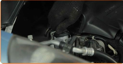
22 Pongan en marcha el motor por unos minutos. Después de que se apague la luz de advertencia de presión del aceite, detenga el motor.
