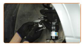
Destornille el soporte del cable ABS. Use un vaso de impacto del n.º 10. Utilice una llave de trinquete.
