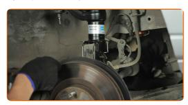
Instale los pernos de sujeción (2 piezas). Utilice una llave de trinquete.
