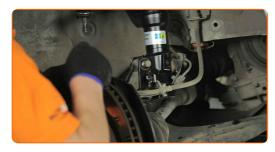
Apriete las sujeciones inferiores que conectan el amortiguador con la mangueta de dirección. Usa una llave mixta del n.º 19. Use un vaso de impacto del n.º 22. Utilice una llave dinamométrica. Apriételo a un par de 157 Nm.
