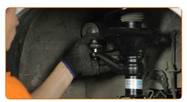
Apriete la tuerca de fijación que conecta el extremo de la barra de acoplamiento a la mangueta de dirección. Usa una llave mixta del n.º 17. Utilice una llave dinamométrica. Apriételo a un par de 43 Nm.
