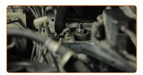
Destornille la fijación superior de la cazoleta de la pata amortiguadora. Use un vaso de impacto del n.º 14. Utilice una llave de trinquete.
