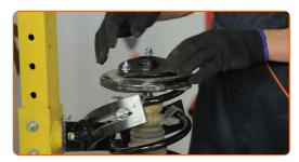
Apriete la tuerca de la varilla de la pata amortiguadora. Usa una llave mixta del n.º 19. Use Vaso HEX No. H7. Utilice una llave dinamométrica. Apriételo a un par de 44 Nm.
