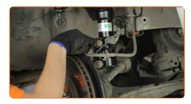
Desatornille la sujeción inferior que conecta el puntal amortiguador a la mangueta de dirección. Usa una llave mixta del n.º 19. Use un vaso de impacto del n.º 22. Utilice una llave de trinquete.
