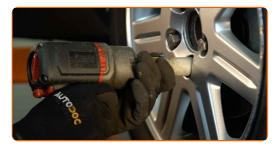
Baje el automóvil y, manteniendo el orden cruzado, apriete los pernos de fijación de las ruedas. Utilice una llave de impacto para llanta # 19. Utilice una llave dinamométrica. Apriételo a un par de 108 Nm.
