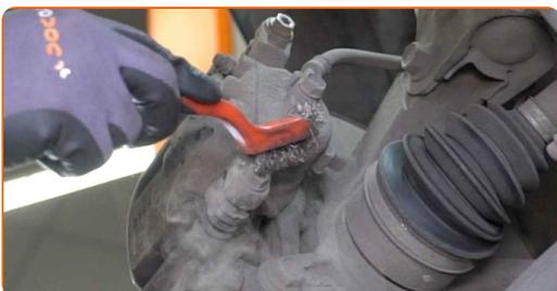
**12** Desenrosque las sujeciones de la pinza de freno. Use una llave mixta del n.º 17. Use un vaso de impacto del n.º 13. Utilice una llave de trinquete.
