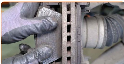
**16** Limpie las sujeciones del soporte de la pinza del freno. Use un cepillo de alambre. Use el aerosol WD-40.
