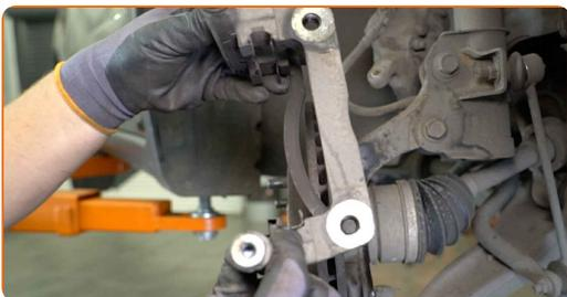
**20** Limpie las sujeciones del disco de freno. Use un cepillo de alambre. Use el aerosol WD-40.
