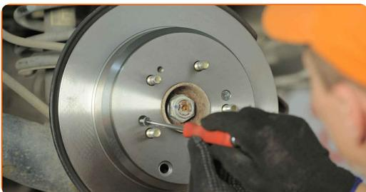
**22** Mueva las zapatas del freno de mano contra el tambor de freno. Utilice un destornillador plano.
