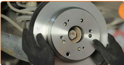
**21** Apriete la fijación del disco de freno. Utilice un destornillador Phillips. Utilice una llave dinamométrica. Apriételo a un par de 9 Nm.
