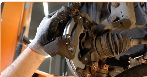
**23** Apriete la fijación de la pinza del cáliper de freno. Use un vaso de impacto del n.º 19. Utilice una llave dinamométrica. Apriételo a un par de 108 Nm.
