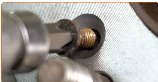
**29** Apriete las sujeciones del disco de freno. Utilice un destornillador Phillips. Utilice una llave dinamométrica. Apriételo a un par de 10 Nm.
