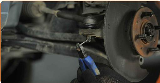
**18** Limpie las sujeciones que conectan el extremo de la barra de acoplamiento con la mangueta de dirección. Use un cepillo de alambre. Use el aerosol WD-40.
