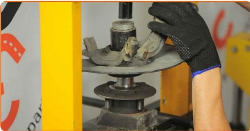
**38** Trate el asiento de montaje del puntal amortiguador en la mangueta de dirección. Use un cepillo de alambre. Use el aerosol WD-40.
