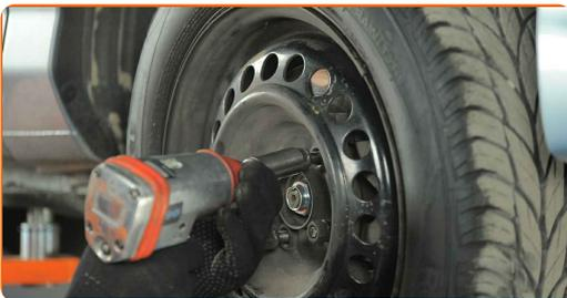
66 Baje el automóvil y, manteniendo el orden cruzado, apriete los pernos de fijación de las ruedas. Utilice una llave de impacto para llanta # 19. Utilice una llave dinamométrica. Apriételo a un par de 108 Nm.
