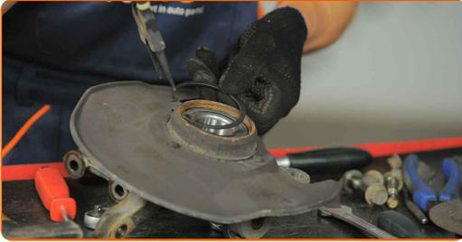
**37** Instale el cubo de rueda en el muñón de dirección. Utilice un juego de cubos y rodamientos.
