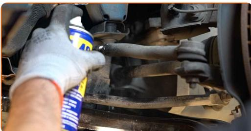
**7** Quite la chaveta que fija la atadura de la punta de la barra de dirección transversal. Use una palanca. Use alicates de punta redondeada.
