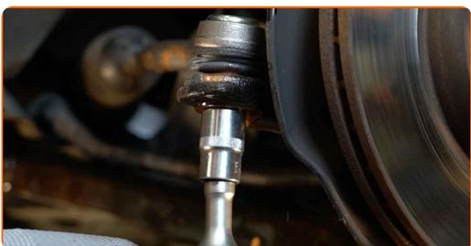
**17** Mida y anote la longitud de la parte libre de la rosca de la barra de dirección o anote la cantidad de las revoluciones completas del detalle durante el desmontaje para que durante el montaje en la medida de lo posible no cambiar el ángulo de convergencia de las ruedas. Utilice un calibrador Vernier.
