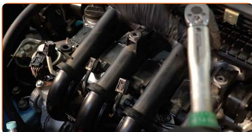
**15** Conecte los conectores de las bobinas del encendido.
