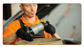
Quite el soporte de fijación del filtro de combustible. Saquen el filtro de combustible.
