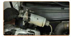
Desatornille el sensor de nivel de agua en el combustible.
