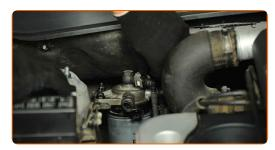
Conecte el conector del sensor de presión de combustible.
