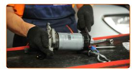
Instale el filtro de combustible nuevo junto con el soporte.
