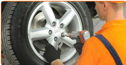
**27** Baje el automóvil y, manteniendo el orden cruzado, apriete los pernos de fijación de las ruedas. Utilice una llave de impacto para llanta # 21. Utilice una llave dinamométrica. Apriételo a un par de 108 Nm.
