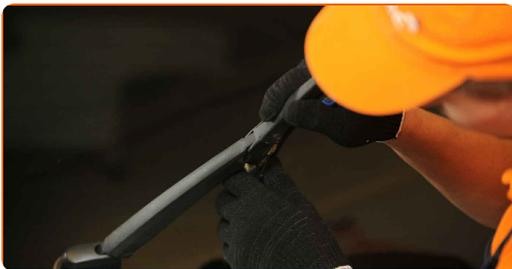
4 Retire la escobilla del brazo del limpiaparabrisas. Utilice un destornillador plano.
