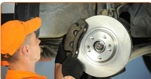
**37** Apriete la fijación de la pinza del cáliper de freno. Usa una llave mixta del n.º 17. Use un vaso de impacto del n.º 17. Utilice una llave dinamométrica. Apriételo a un par de 85 Nm.
