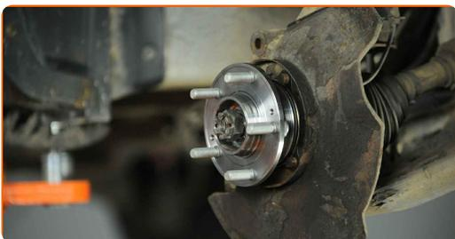
**32** Apriete la tuerca del cubo de rueda. Use un vaso de impacto del n.º 32. Utilice una llave dinamométrica. Apriételo a un par de 195 Nm.
