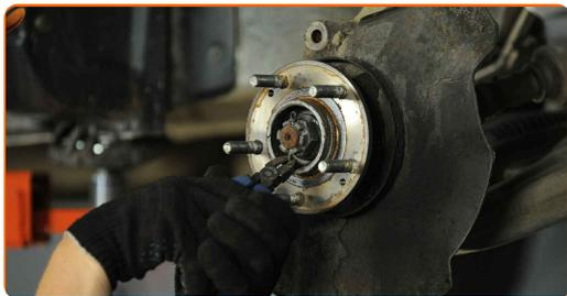
**12** Desenrosque la tuerca del cubo. Use un vaso de impacto del n.º 32. Utilice una llave de trinquete.
