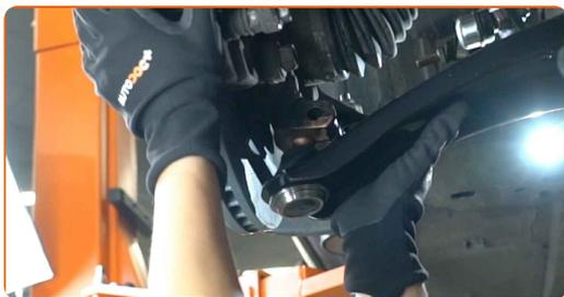
**28** Instale el perno de sujeción. Utilice un martillo.
