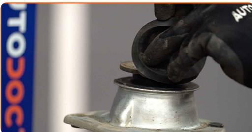
21 Limpie la barra del amortiguador. Use el aerosol WD-40.
