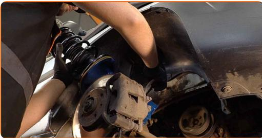
33 Atornillen la fijación superior de la cazoleta de la pata amortiguadora. No lo apriete.
