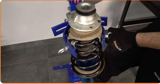
31 Retire el puntal amortiguador que está montado.
