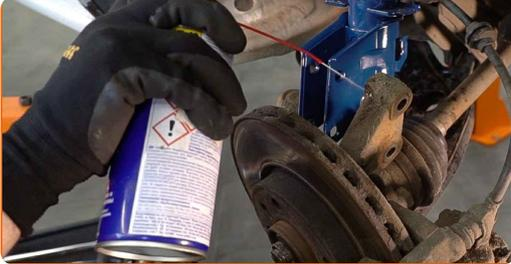
**36** Fije la pata amortiguadora en el muñón de dirección. Use una palanca.
