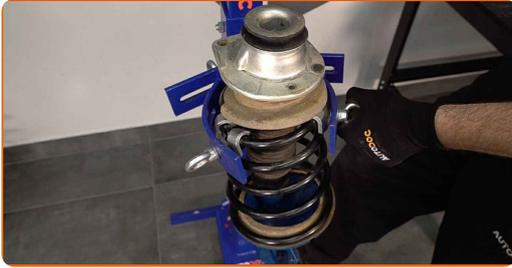
35 Retire el puntal amortiguador que está montado.
