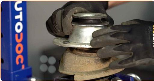
33 Apriete la tuerca de la varilla de la pata amortiguadora. Use un vaso de impacto del n.º 19. Use Vaso HEX No. H6. Utilice una llave dinamométrica. Apriételo a un par de 65 Nm.
