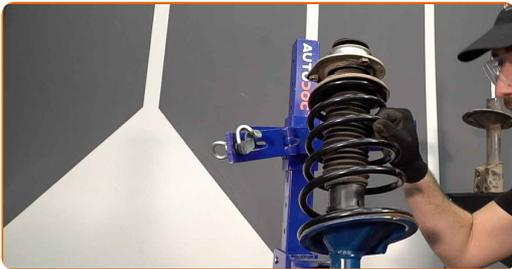
36 Instale la pata amortiguadora en el arco de la rueda.
