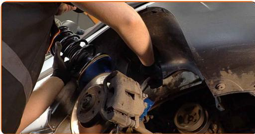
37 Atornillen la fijación superior de la cazoleta de la pata amortiguadora. No lo apriete.
