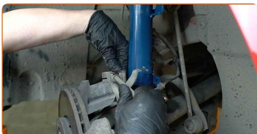
**65** Conecte los cables del captador ABS. Use alicates de bomba de agua.
