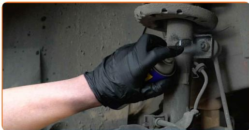
**13** Desatornille la sujeción que conecta la bieleta de barra estabilizadora al amortiguador. Use un vaso de impacto del n.º 17. Utilice una llave de trinquete.
