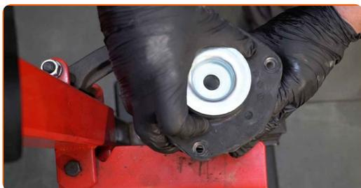
**42** Apriete la tuerca de la varilla de la pata amortiguadora. Use Vaso HEX No. H7. Use un vaso de impacto del n.º 21. Utilice una llave dinamométrica. Apriételo a un par de 60 Nm.
