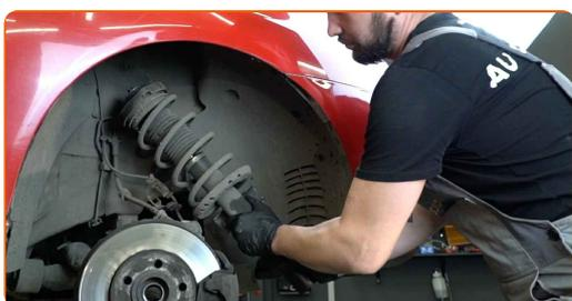
**32** Instale la pata amortiguadora en el mecanismo para apretar los resortes.
