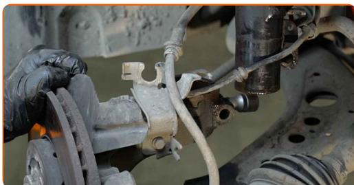
**30** Destornille la fijación superior de la cazoleta de la pata amortiguadora.
