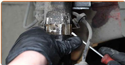
**17** Desconecte el latiguillo de freno. Use una palanca.
