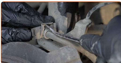
**18** Desconecte el cableado del captador ABS.
