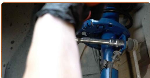
**68** Trate las sujeciones del amortiguador. Trate todas las articulaciones del brazo. Use grasa de cobre.
