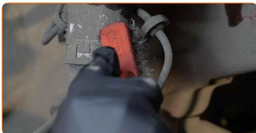
**16** Retire el clip de retención del latiguillo de freno.
