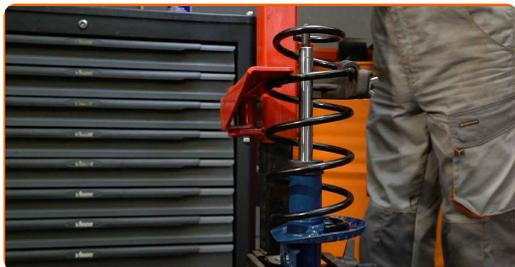
**41** Instale el soporte, el fuelle y el tope en el amortiguador.
