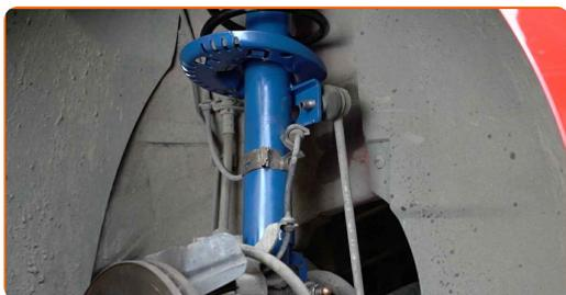
**67** Apriete la sujeción que conecta la bieleta de barra estabilizadora al amortiguador. Use un vaso de impacto del n.º 17. Utilice una llave dinamométrica. Apriételo a un par de 40 Nm.
