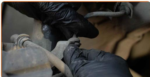
**19** Limpie las sujeciones que conectan el puntal amortiguador a la mangueta de dirección. Use un cepillo de alambre. Use el aerosol WD-40.
