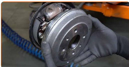
**31** Mueva las zapatas del freno de mano contra el tambor de freno. Utilice un destornillador plano.
