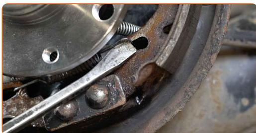
**16** Retire los pasadores de sujeción de las zapatas de freno. Use alicates de punta redondeada.
