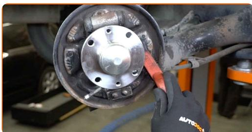
**22** Instale los resortes de parada superiores y el mecanismo de ajuste en las pastillas de freno nuevas.
