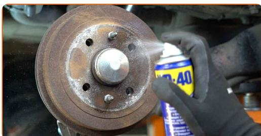
**8** Destornille la fijación del tambor de freno. Use un vaso de impacto del n.º 12. Utilice una llave de trinquete.
