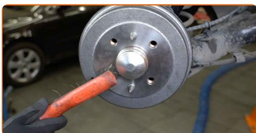
**39** Trate la superficie en la cual la llanta de la rueda entra en contacto con el tambor del freno. Use grasa de cobre.
