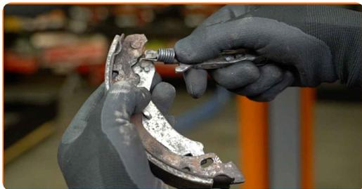
**21** Limpie los asientos de montaje de las zapatas de freno. Use un cepillo de alambre. Utilice un spray de limpieza multiuso.
