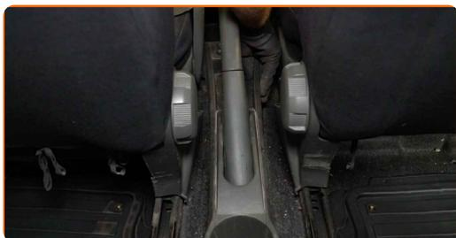
**35** Atornille las sujeciones delanteras de la consola central inferior. Use un vaso de impacto del n.º 10. Utilice una llave de trinquete.
