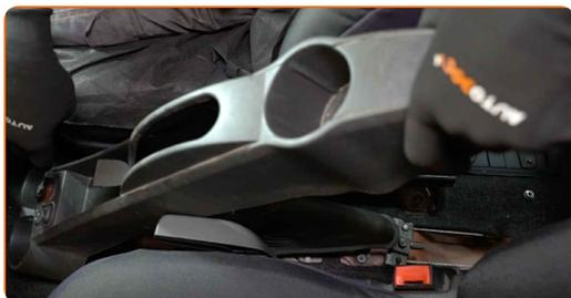
**12** Suelte el cable del freno de mano. Usa una llave mixta del n.º 10.
