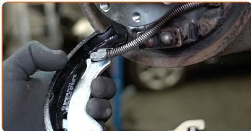
**24** Instale las zapatas de freno en el cilindro de freno secundario y en el soporte del escudo de apoyo.
