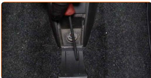
**10** Desatornille las sujeciones delanteras de la consola central inferior. Use un vaso de impacto del n.º 10. Utilice una llave de trinquete.
