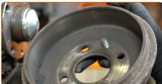
**14** Limpie las sujeciones de las zapatas de freno. Use un cepillo de alambre. Use el aerosol WD-40.
