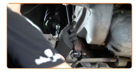
Apriete la sujeción que conecta la bieleta a la barra estabilizadora. Use un vaso de impacto del n.º 17. Utilice una llave dinamométrica. Apriételo a un par de 23 Nm.
