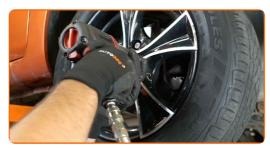
Baje el automóvil y, manteniendo el orden cruzado, apriete los pernos de fijación de las ruedas. Utilice una llave de impacto para llanta # 17. Utilice una llave dinamométrica. Apriételo a un par de 98 Nm.
