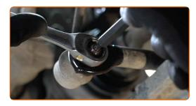
Desatornille la sujeción que conecta la bieleta de barra estabilizadora al amortiguador. Use un vaso de impacto del n.º 16. Utilice una llave de trinquete.
