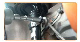
Retire el enlace estabilizador de estabilidad transversal.
