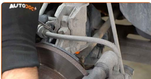
**11** Limpie las sujeciones de la bieleta o enlace estabilizador. Use un cepillo de alambre. Use el aerosol WD-40.
