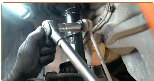
**49** Trate la sujeción superior del soporte del puntal de suspensión. Use grasa de cobre.
