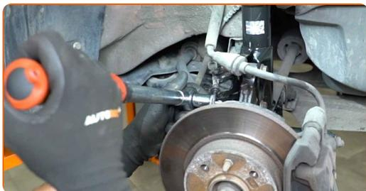
**46** Conecte los cables del captador ABS. Conecte la manguera del freno. Use una palanca.
