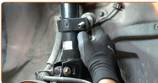
**48** Apriete la sujeción que conecta la bieleta de barra estabilizadora al amortiguador. Use un vaso de impacto del n.º 16. Utilice una llave dinamométrica. Apriételo a un par de 23 Nm.
