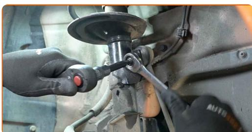
**13** Retire el enlace estabilizador de estabilidad transversal.
