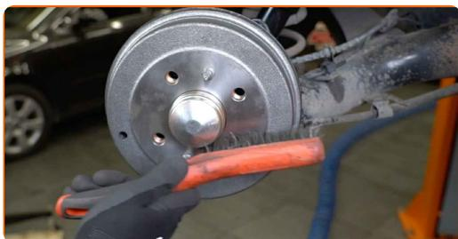
**25** Trate la superficie en la cual la llanta de la rueda entra en contacto con el tambor del freno. Use grasa de cobre.
