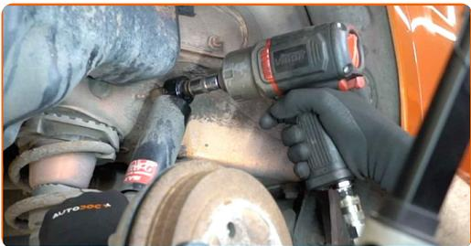
**9** Retire el perno de sujeción.
