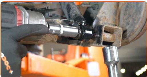
**11** Retire el perno de sujeción.
