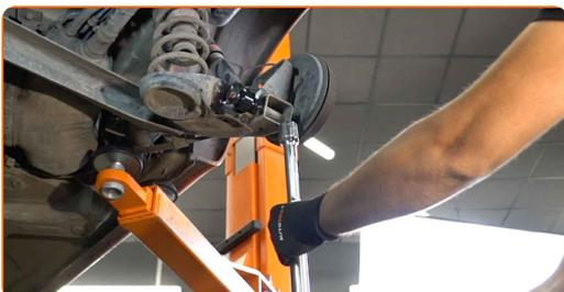
**8** Destornille la fijación superior del amortiguador. Use un vaso de impacto del n.º 15. Utilice una llave de trinquete.
