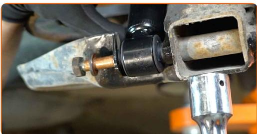
**18** Atornille la sujeción inferior del amortiguador. Use un vaso de impacto del n.º 19. Utilice una llave de trinquete.
