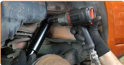
**17** Instale el perno de sujeción.
