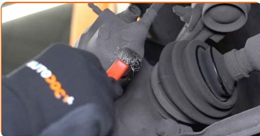
**9** Destornille la fijación del cáliper de freno. Use Vaso HEX No. H6. Utilice una llave de trinquete.
