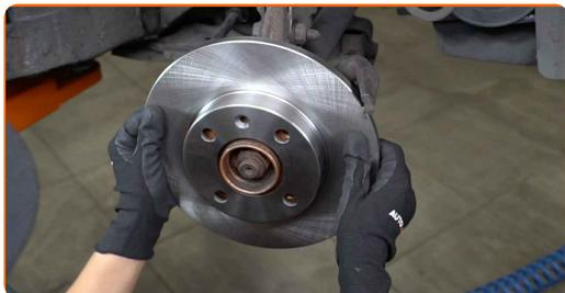
**19** Apriete la fijación del disco de freno. Utilice Torx T30. Utilice una llave dinamométrica. Apriételo a un par de 4 Nm.
