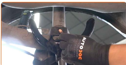
**21** Atornille la sujeción inferior del puntal de suspensión. Usa una llave mixta del n.º 17. Use un vaso de impacto del n.º 17. Utilice una llave giramachos.
