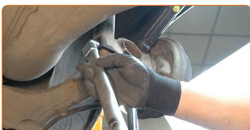
**23** Atornillen la fijación superior de la cazoleta de la pata amortiguadora. No lo apriete.
