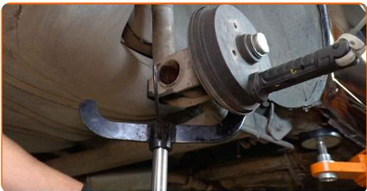
**13** Desenrosque la sujeción superior que conecta el puntal de suspensión con la mangueta de dirección.
