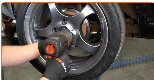
**29** Baje el automóvil y, manteniendo el orden cruzado, apriete los pernos de fijación de las ruedas. Utilice una llave de impacto para llanta # 17. Utilice una llave dinamométrica. Apriételo a un par de 110 Nm.
