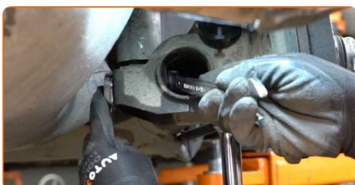
**22** Apriete la fijación inferior de la pata amortiguadora. Usa una llave mixta del n.º 17. Use un vaso de impacto del n.º 17. Utilice una llave dinamométrica. Apriételo a un par de 70 Nm.
