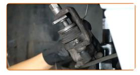
Establezcan el soporte de freno y lo fijen. Use Vaso HEX No. H7. Utilice una llave dinamométrica. Apriételo a un par de 25 Nm.
