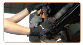
Separe las pastillas de freno. Use una palanca.
