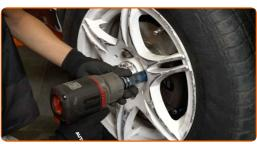
Baje el automóvil y, manteniendo el orden cruzado, apriete los pernos de fijación de las ruedas. Utilice una llave de impacto para llanta # 17. Utilice una llave dinamométrica. Apriételo a un par de 110 Nm.
