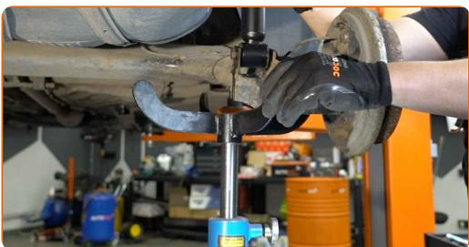
**38** Instale el perno de sujeción.
