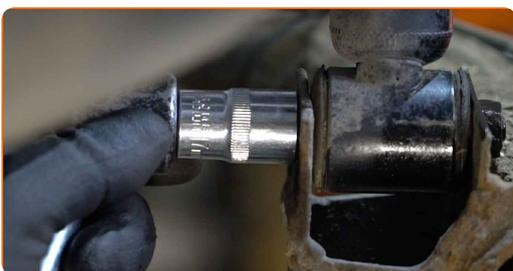
**15** Destornille la fijación superior de la cazoleta de la pata amortiguadora.
