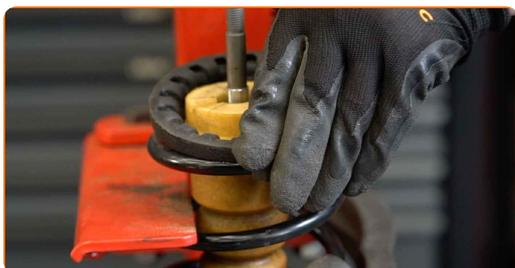
**30** Instale el soporte de montaje superior del puntal y el cojinete del soporte de montaje del puntal.
