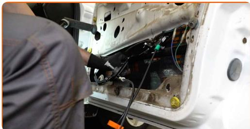
**15** Apriete las sujeciones del ensamblaje del regulador de ventana. Use un vaso de impacto del n.º 10. Utilice una llave dinamométrica. Apriételo a un par de 10 Nm.
