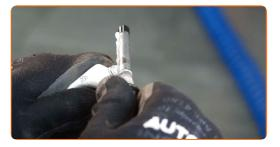
Establezcan el soporte de freno y lo fijen. Use un vaso de impacto del n.º 14. Utilice una llave dinamométrica. Apriételo a un par de 43 Nm.
