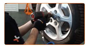
Baje el automóvil y, manteniendo el orden cruzado, apriete los pernos de fijación de las ruedas. Utilice una llave dinamométrica. Apriételo a un par de 108 Nm.
