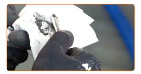
Lubrique los pernos de guía con el lubricante de freno especial.
