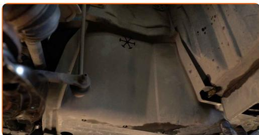
17 Instale y apriete las sujeciones de la cubierta del paso de rueda.
