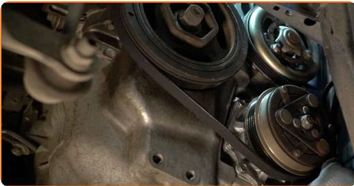
**13** Vuelva a colocar la polea tensora en su posición inicial. Usa una llave mixta del n.º 14.
