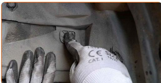
18 Apriete los sujetadores de la cubierta inferior del cárter de aceite. Utilice un destornillador Phillips.
