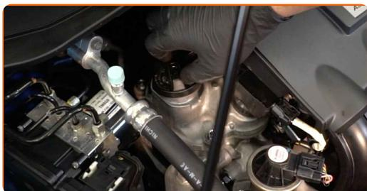
**28** Pongan en marcha el motor por unos minutos. Después de que se apague la luz de advertencia de presión del aceite, detenga el motor.
