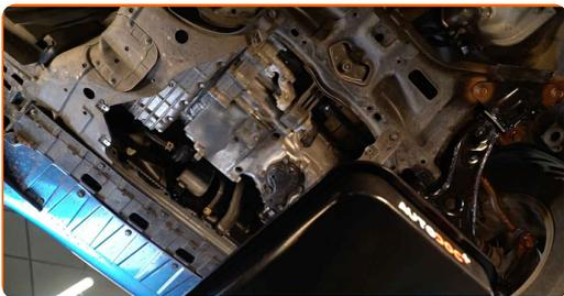
**8** Limpie el área del orificio de drenaje de la bandeja de aceite. Use un cepillo de alambre. Utilice un spray de limpieza multiuso.
