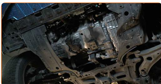
**7** Coloque un contenedor para el aceite de desecho con al menos 4 l de capacidad debajo del orificio de drenaje.
