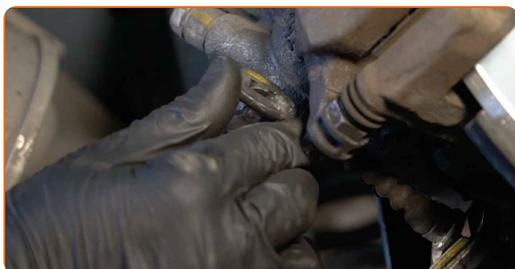
**36** Trate la superficie donde el disco del freno entra en contacto con la llanta de la rueda. Use grasa de cobre.
