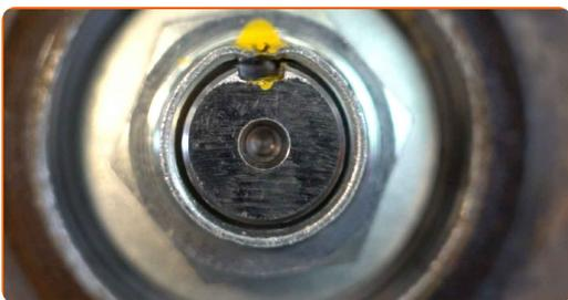
**20** Destornille la fijación del cubo de la rueda. Use un vaso de impacto del n.º 32. Utilice una llave giramachos.
