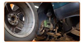
Limpie las sujeciones que conectan el extremo de la barra de acoplamiento con la mangueta de dirección. Use un cepillo de alambre. Use el aerosol WD-40.
