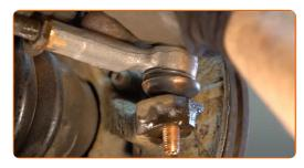
Mida y anote la longitud de la parte libre de la rosca de la barra de dirección o anote la cantidad de las revoluciones completas del detalle durante el desmontaje para que durante el montaje en la medida de lo posible no cambiar el ángulo de convergencia de las ruedas. Utilice un calibrador Vernier.
