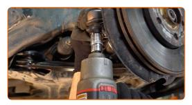
Apriete la tuerca de fijación que conecta el extremo de la barra de acoplamiento a la mangueta de dirección. Use un vaso de impacto del n.º 17. Utilice una llave dinamométrica. Apriételo a un par de 45 Nm.
