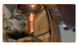
Conecte la punta de la barra de dirección al muñón de dirección.
