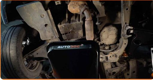
3 Limpie el área del orificio de drenaje de la bandeja de aceite. Use un cepillo de alambre. Utilice un spray de limpieza multiuso.
